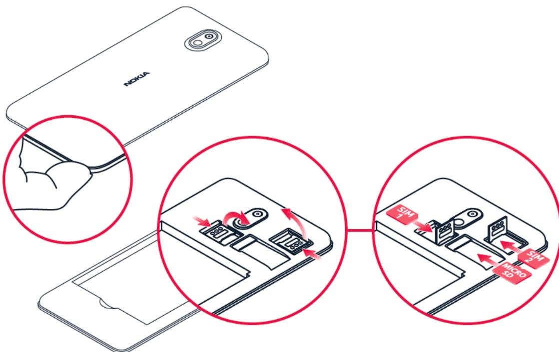
1. Le téléphone orienté vers le bas, placez votre ongle dans la fente entre le capot arrière et l'écran, pliez le capot arrière pour l'ouvrir et retirez-le.
