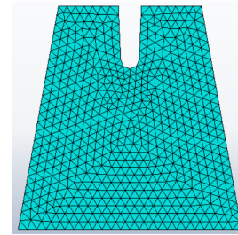
FIGURE 7.6 – Maillage (grossier) du trapèze avec une densité de 2 mm
