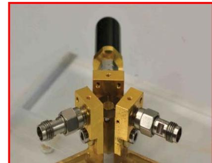
Circulateur microonde à base de nanofils magnétiques dans une matrice oxyde
